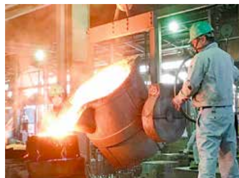
電気炉の注湯作業
