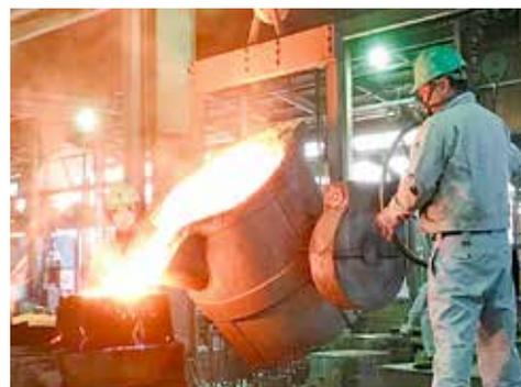
電気炉の注湯作業
